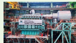
世界初号機となるアンモニア焚き大型低速エンジン
