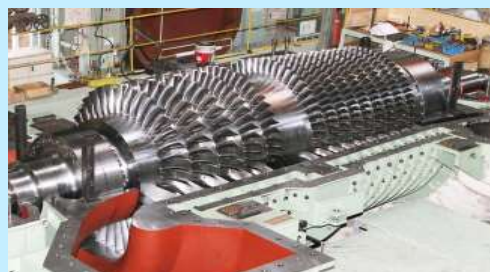
高炉送風機、炉頂圧回収タービン
