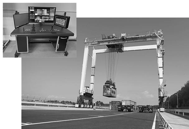
写真1 遠隔・自働運転開発用トランスターナ<sup>®</sup>
